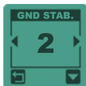
GND STAB. pode ser ajustada de 1 a 3 e é usada para definir o nível de instabilidade / feedback do solo que você está preparado para tolerar.
