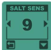
Além da configuração geral de sensibilidade, a configuração «SALT SENS» tem a vantagem de reduzir os sinais falsos, normalmente ligados à água do mar, ao contrário da sensibilidade geral que atua em todos os alvos e em todos os sinais. Ao pesquisar areia molhada ou no vai e vem das ondas, sempre use a configuração SALT SENS como prioridade em vez da sensibilidade geral. A sensibilidade geral deve ser reservada para os casos em que as instabilidades provêm de interferência eletromagnética (EMI).
