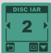
Programas 8 GOLD FIELD e 9 RELIC FIELD use outro método de discriminação, chamado IAR (Iron Amplitude Rejeição). Isso permite a rejeição de itens ferrosos de acordo com sua distância da bobina com o alvo.
