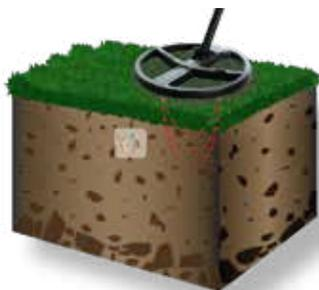
Posicione a bobina um pouco acima do chão e ao lado do alvo. Pressione
