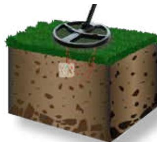
Para estreitar o campo de detecção e melhorar a localização do alvo: Posicione a bobina perto do alvo, mas não no centro. Pressione
