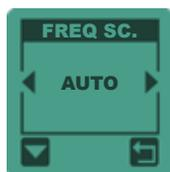
Esta função ativa uma varredura automática das frequências de detecção e indica um canal limpo com a menor interferência a cada mudança de programa ou a cada mudança de frequência no programa MONO. A varredura de frequência é particularmente rápida em DEUS II, no entanto, irá retardar a sua navegação em 2 segundos, ao mudar de programa.
