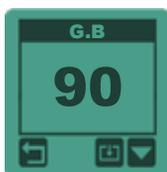
Pressione para acessar G.B. (balanço de Solo) e pressione 2 segundos para entrar nas configurações G.B.
